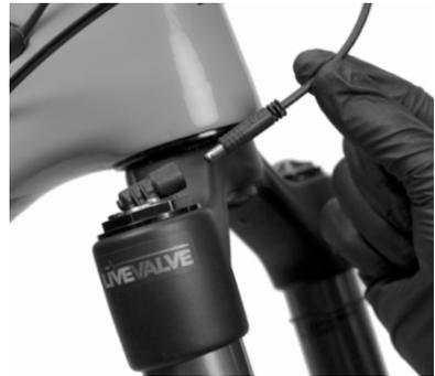
9. Federn Sie die Gabel bis zum Anschlag ein und achten Sie darauf, dass das Kabel mit einer Zugentlastungsschleife verlegt ist und es sich über den gesamten Federweg der Gabel hinweg frei bewegen kann. Überprüfen Sie, dass das Kabel so ausgerichtet ist, dass es die Gabelbrücke nicht berührt und nicht eingequetscht wird.
