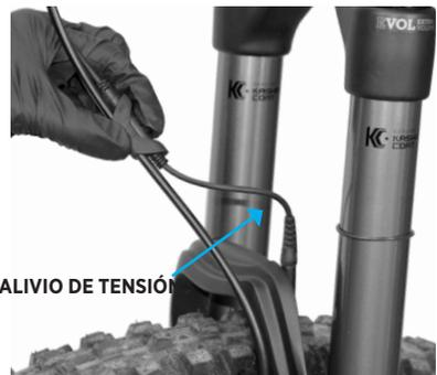
4. Instale una brida de plástico alrededor del centro del clip del sensor.
