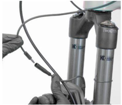
3. 务必将传感器接头置于刹车线的上方，并且最靠近前叉。先将传感器夹子卡在刹车线，然后卡住传感器接头。线缆**必须**形成应力释放弯曲状，以便在前叉的整个行程过程中线缆仍能自由移动。
