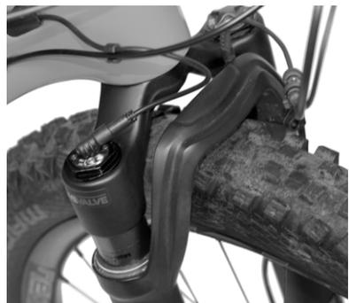
10. Installez un clip de câble pour maintenir le câble électromagnétique avant et l'autre câble ensemble, près du tube de direction.
