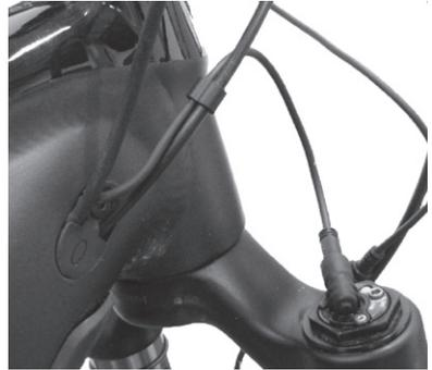
11. Drehen Sie den Lenker bis zum Anschlag nach rechts und nach links. Überprüfen Sie, dass sich die Kabel ohne übermäßig viel Spannung, Behinderung oder enge Biegeradien bewegen können.
