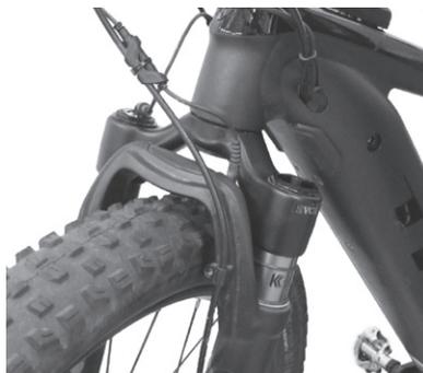
7. Il cavo del solenoide anteriore ha un'estremità jack CC. Instradare il cavo del solenoide anteriore in modo che non vi siano curve strette o ostruzioni da altri cavi.
