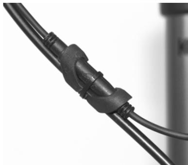
5. Junto al tubo de cabeza, instale un clip de cable en el cable del sensor delantero y el otro cable.
