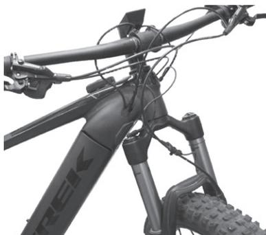
12. Vérifiez que le capteur arrière ne touche pas le disque de frein et qu'il est parfaitement fixé.
