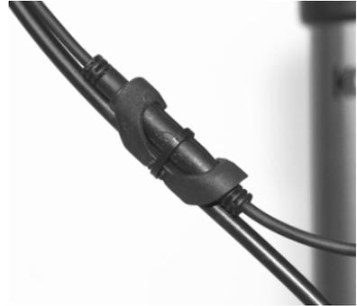
5. Bringen Sie in der Nähe des Steuerrohrs eine Kabelschelle am Frontsensorkabel und dem anderen Kabel an.
