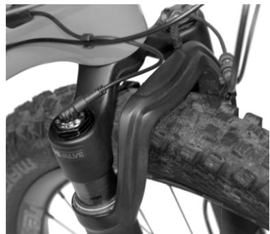
10. Bringen Sie in der Nähe des Steuerrohrs eine Kabelschelle an, um das Frontmagnetventilkabel an dem anderen Kabel zu befestigen.
