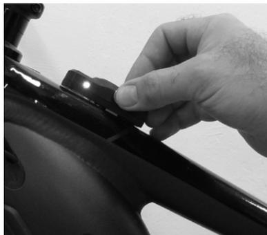
6. 校准完成后，LED 将改变颜色，蓝灯将闪烁。
