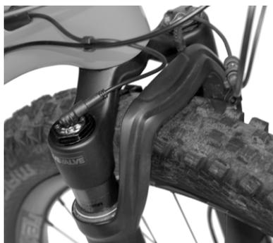
10. 在靠近车头管之处，用一个线缆夹夹住前轮电磁阀线缆和另一条线缆。
