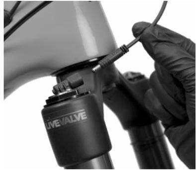
9. Comprimez la fourche jusqu'à ce qu'elle talonne et laissez une longueur supplémentaire de câble pour permettre au câble de bouger librement lors des mouvements de la fourche. Vérifiez que le câble est bien positionné, qu'il n'est pas tordu et qu'il ne touche pas l'arceau de la fourche.
