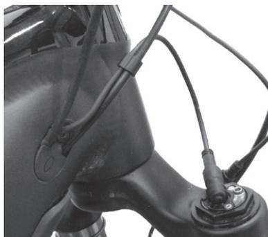
11. 将车把左右转动到底。确保所有线缆都能自由移动，而没有过大的张力，也没有阻碍或剧烈弯折。
