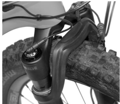
10. Junto al tubo de cabeza, instale un clip de cable para unir el cable del solenoide delantero y el otro cable.
