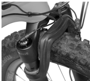
10. Installare una clip per cavi vicino al tubo dello sterzo sulla parte anteriore del cavo del solenoide e un altro cavo.
