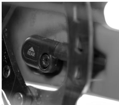
13. Verifique que a presilha para cabo em volta do reservatório do amortecedor foi instalada na fábrica. Note que há mais do que uma posição para o cabo e para o reservatório.
