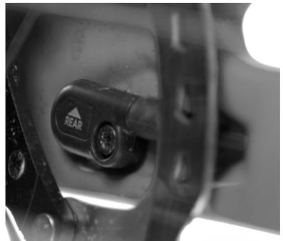
13. Überprüfen Sie, dass ab Werk eine Kabelschelle am Dämpfer-Ausgleichsbehälter angebracht ist. Beachten Sie, dass es für Kabel und Ausgleichsbehälter mehr als eine Position gibt.
