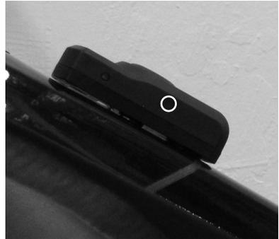
4. Coloque un imán sobre el sensor del controlador como se muestra.
