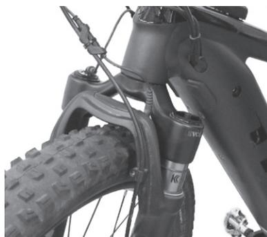
7. El cable del solenoide delantero presenta un conector CC en su extremo. Dirija el cable del solenoide delantero de forma que no queden curvas cerradas ni obstrucciones con otros cables.
