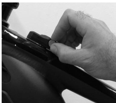
5. Se il magnete viene rilevato correttamente, un LED verde inizierà a lampeggiare. Continuare a mantenere il magnete in posizione per circa 10 secondi.
