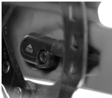
13. 确认在出厂时线缆夹已缠绕在后减震器储气罐。请注意，线缆和储气罐的缠绕位置不止一处。
