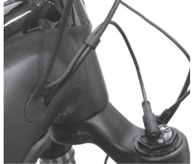
11. Gire el manillar hacia la derecha y hacia la izquierda. Compruebe que todos los cables se mueven libremente sin tensión excesiva, obstrucciones ni curvas cerradas.
