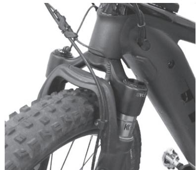
7. Das Frontmagnetventilkabel ist mit einem Gleichstromanschlussstecker versehen. Verlegen Sie das Frontmagnetventilkabel so, dass keine engen Biegeradien entstehen oder Behinderungen durch andere Kabel auftreten.
