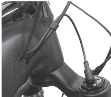
11. Gire o guidador totalmente para a direita e para a esquerda. Verifique que os cabos se movem livremente sem tensão excessiva, nem obstrução nem curvas apertadas.
