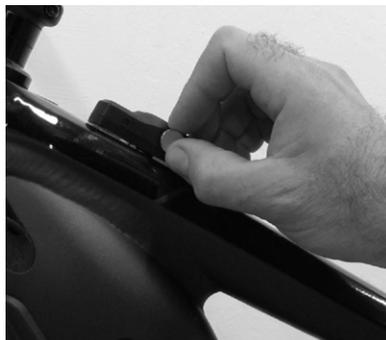
5. Si le système détecte l'aimant, une LED verte va s'allumer. Maintenez l'aimant dans cette position pendant environ 10 secondes.
