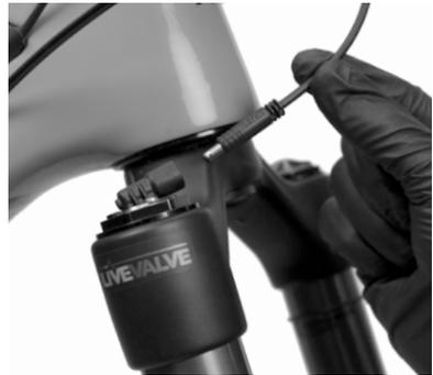
9. Comprima la horquilla hasta el fondo y asegúrese de que quede un bucle de alivio de tensión en el cable y que este permite que el cable se mueva libremente en todo el recorrido de la horquilla. Compruebe que el cable se orienta de forma que pueda separarse de la abrazadera de la horquilla sin quedar atrapado.
