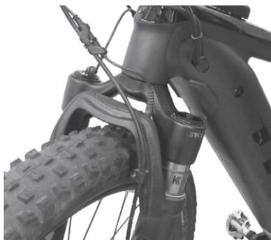
7. 前轮电磁阀线缆带有直流电源插头。布置前轮电磁阀线缆，使其没有剧烈弯折，亦不受其它线缆的阻碍。
