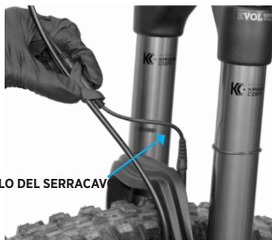
4. Installare una fascetta attorno al centro della clip del sensore.
