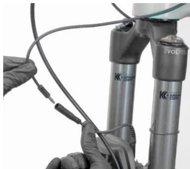
3. Assicurarsi di orientare il connettore del sensore sulla parte superiore del tubo del freno e il più vicino possibile alla forcella. Fissare la clip del sensore clip al tubo del freno prima e quindi fissarla al connettore del sensore. **Deve** essere presente un anello del serracavo nel cavo in modo che possa muoversi liberamente quando la forcella compie la sua corsa.
