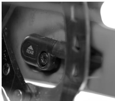
13. Vérifiez que le clip du câble fixé autour du réservoir de l'amortisseur arrière a bien été mis en place en usine. Veuillez noter qu'il existe plusieurs positions pour le câble et pour le réservoir.
