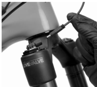
9. Comprimerne la forcella a fondo e verificare che sia presente un anello del serracavo nel cavo e che possa muoversi liberamente quando la forcella compie la propria corsa. Verificare che il cavo sia orientato per liberare l'archetto della forcella senza pizzicarlo.
