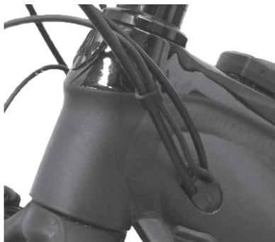
6. 卸下前叉气阀盖。用六角扳手释放气阀内的所有空气。按压前叉，使其触底。确保在前叉的整个行程过程中，线缆的应力释放弯曲状能让线缆自由移动。
