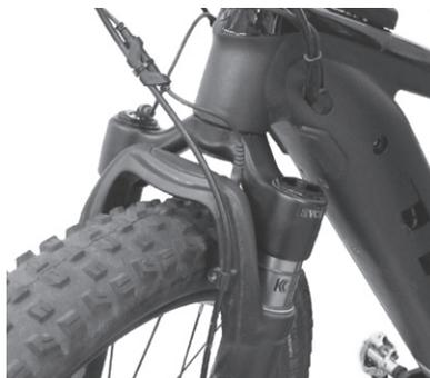
7. Le câble électromagnétique avant est équipé d'une prise jack CC. Installez le câble électromagnétique avant en laissant du mou et en veillant à ce qu'il n'interfère pas avec les autres câbles.
