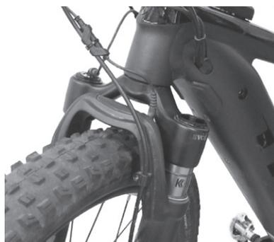
7. O cabo do solenóide da frente tem uma ficha tipo DC na extremidade do cabo. Encaminhe o cabo do solenóide da frente de modo que não haja curvas apertadas nem obstruções de outros cabos.
