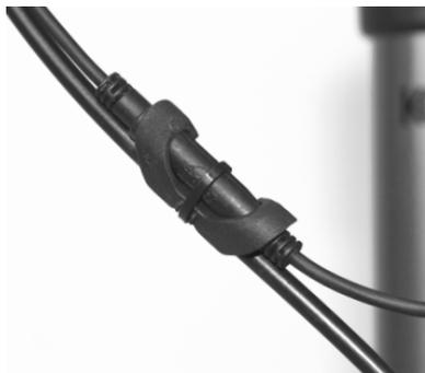
5. 在靠近车头管之处，用一个线缆夹夹住前轮传感器线缆和另一条线缆。
