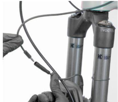
3. Asegúrese de orientar el conector del sensor por encima del cable del freno y lo más cerca posible de la horquilla. Enganche primero el clip del sensor al cable del freno y luego al conector del sensor. **Debe** quedar un bucle de alivio de tensión en el cable para que pueda moverse libremente en todo el recorrido de la horquilla.
