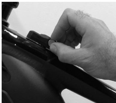
5. 如果成功检测到磁铁，LED 绿灯将开始闪烁。
