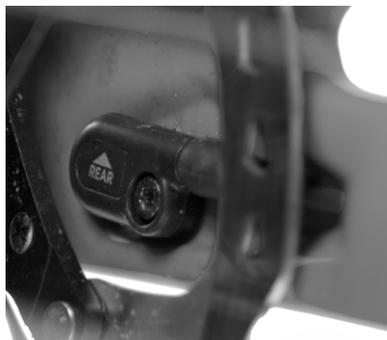
13. Verificare che la clip del cavo intorno al serbatoio dell'ammortizzatore sia installato dalla fabbrica. Notare che è disponibile più di una posizione per il cavo e il serbatoio.
