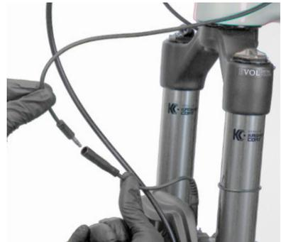
3. Achten Sie darauf, dass Sie den Sensoranschluss so ausrichten, dass er über der Bremsleitung und eng an der Gabel liegt. Befestigen Sie die Sensorschelle zuerst an der Bremsleitung und dann am Sensoranschluss. Das Kabel **muss** mit einer Zugentlastungsschlaufe verlegt werden, sodass es sich über den gesamten Federweg der Gabel hinweg frei bewegen kann.
