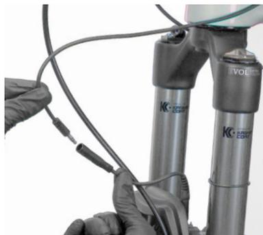
3. Vérifiez que le connecteur du capteur se situe au-dessus du câble de frein et le plus proche de la fourche. Pour commencer, attachez le clip du capteur sur le câble de frein puis connectez-le au capteur. Il **faudrait** laisser une longueur supplémentaire de câble afin qu'il puisse bouger librement lors des mouvements de la fourche.
