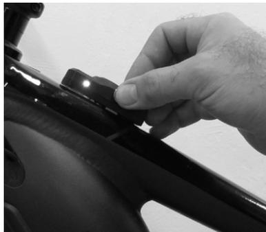
6. Al termine della taratura, il LED cambierà colore e visualizzerà una serie di lampeggi blu.
