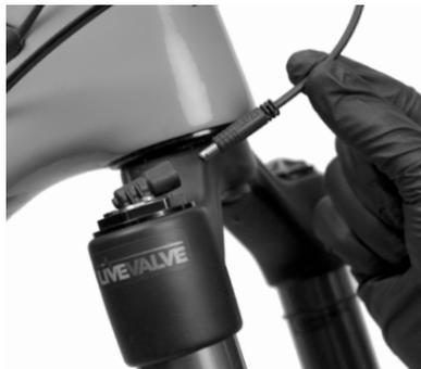
9. 按压前叉，使其触底。线缆必须形成应力释放弯曲状，以便在前叉的整个行程过程中线缆仍能自由移动。检查线缆的朝向，确保线缆与叉桥之间留有间隙，不会挤压叉桥。
