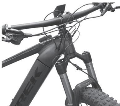
12. 确认后轮传感器已牢固安装，并与后轮刹车碟之间留有空隙。
