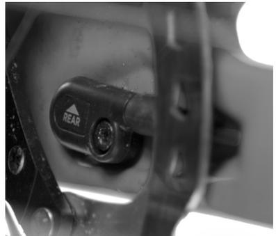
13. Compruebe que el clip de cable alrededor del depósito del amortiguador viene instalado de fábrica. Tenga en cuenta que hay más de una posición para el cable y el depósito.
