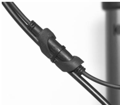
5. Installare una clip per cavi vicino al tubo di sterzo sul cavo del sensore anteriore e l'altro cavo.
