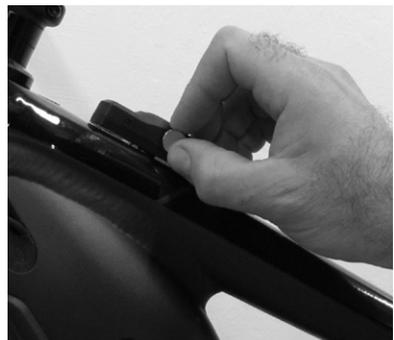
5. Sobald der Magnet erkannt wird, beginnt eine grüne LED zu blinken. Halten Sie den Magneten etwa 10 Sekunden lang in dieser Position.
